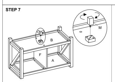
A. ATTACH CENTER LEG (M) TO THE BACK OF SHELF (B) AS SHOWN.
